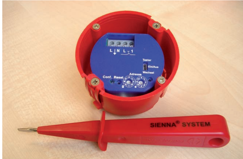
Bild 1: Gebäudeautomation aus der UP-Dose - programmiert per Schraubendreher
