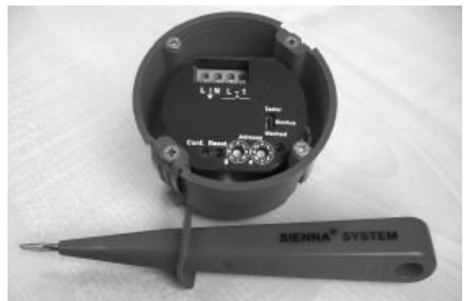
Alle Komponenten sind so dimensioniert, dass sie in einer Unterputzdose eingebaut werden können.
